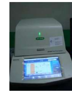
เครื่องเพิ่มปริมาณสารพันธุกรรมแบบสภาพจริง
