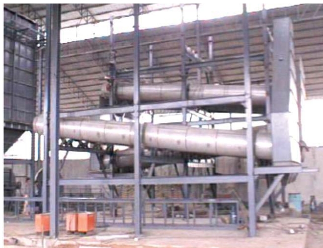
ภาพที่ 2.14 เครื่องอบแห้งแบบโรตารี
